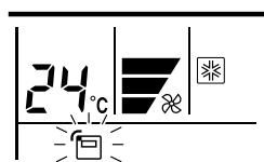
Нажмите кнопку датчика температуры (THERMO SENSOR) для выбора комнатной температуры, определяемой внутренним устройством (дистанционный датчик) или пультом дистанционного управления.
