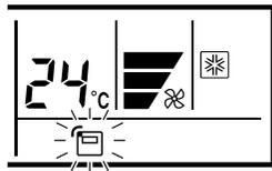
Нажмите кнопку датчика температуры (THERMO SENSOR) для выбора комнатной температуры, определяемой внутренним устройством (дистанционный датчик) или пультом дистанционного управления.
