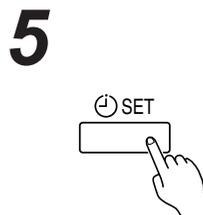
Повторите действия **3** и **4**. Нажмите и удерживайте кнопку SET 2 секунды или более для сохранения настройки таймера специальной температуры.
